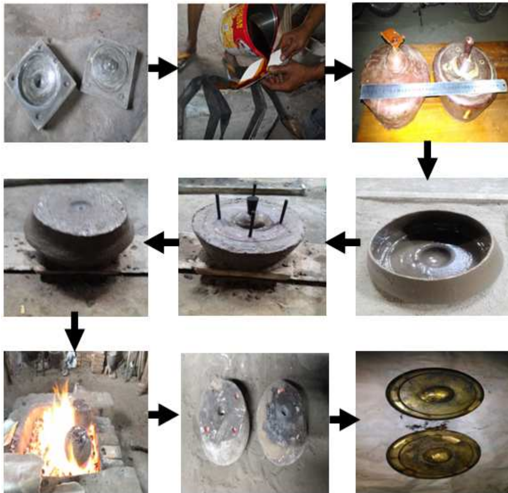
Gambar 6. Urutan proses aplikasi metode investment casting
