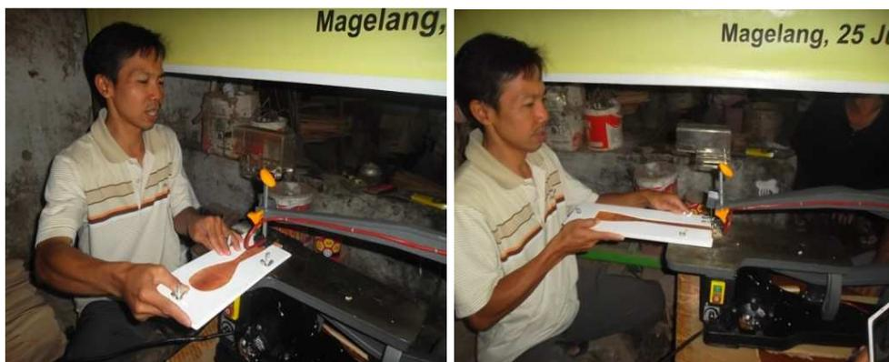
**Gambar 9. Proses pemotongan menggunakan mesin gergaji dengan mal pembentuk (program IbM)**
