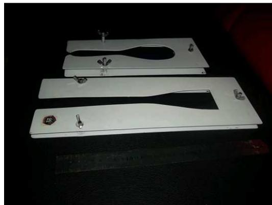
**Gambar 7. Mal pembentuk dibuat dari plat baja (program IbM)**
