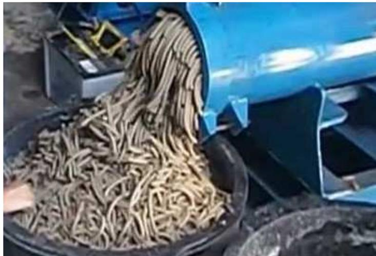
Gambar 3. Mesin pembuat pellet pakan
