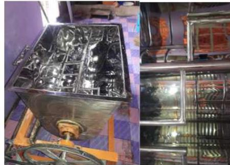
Gambar 6 Mesin pencampur adonan
