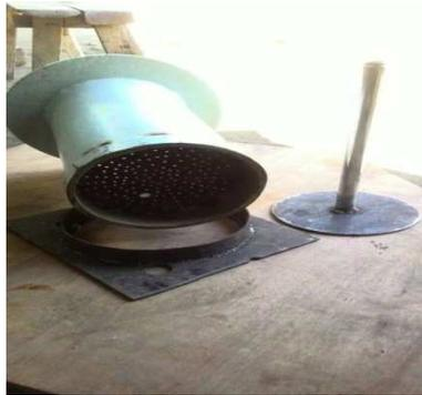
Gambar 4. Wadah Pengepres Minyak santan Kelapa
