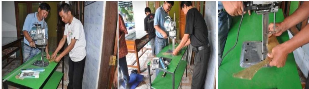
Gambar 8. a,b, c: Mesin Potong Kulit digunakan untuk memotong kulit (sapi/kerbau/kambing) dengan bentuk & ukuran yang diinginkan. Pisau potong dilengkapi dengan pengasahan secara otomatis. Pisau potong terbuat dari baja stainless, disediakan 1 kotak berisi 12 bilah pisau potong. Sehingga ada kemudahan penggantian pisau potong.
