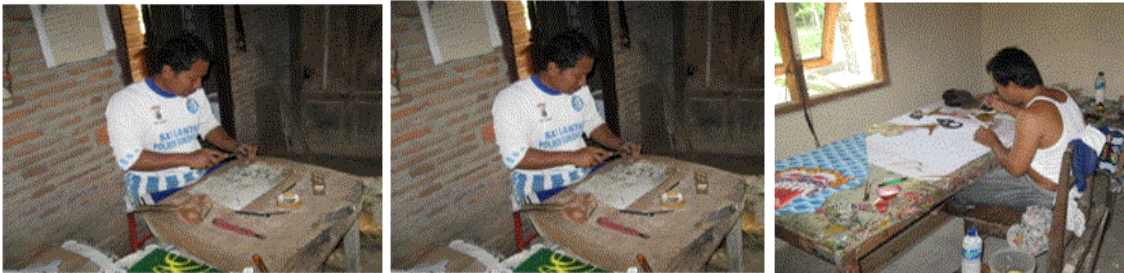
Gambar 4. a, b, c: Proses tatah sungging pada UKM1 Mitra dan UKM2 Mitra. Proses tatah menghasilkan “wayang putihan”. Kedua proses ini menggunakan alat sederhana, dalam pengerjaannya, kurang memperhatikan aspek kebersihan.
