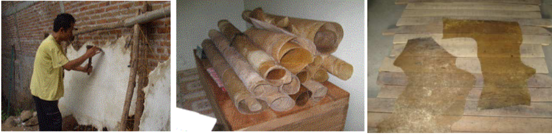
Gambar 3. a, b, c: Proses pengerokan dengan alat pentang yang sangat sederhana sehingga kulit bergerak saat dikerok. Penyimpanan kulit hanya diletakkan begitu saja sehingga tingkat kerusakan cukup tinggi. Demikian pula proses penjidaran yang kurang optimal karena layout gudang kurang sinar matahari sehingga kulit rentan berjamur.
