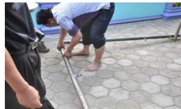
Gambar 7a, b: Perbaikan proses pengerokan dilakukan dengan membuat alat kerok dan alat perentang yang lebih kuat (dari pipa besi) dengan detail sesuai luas kulit kerbau.
