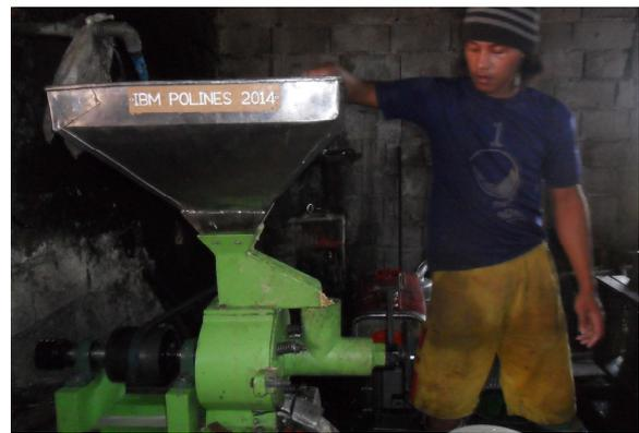
**Gambar 2. Mesin penggiling kedelai**
