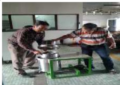
Gambar 20. Pengabdi sedang assembling mesin pemeras santan
