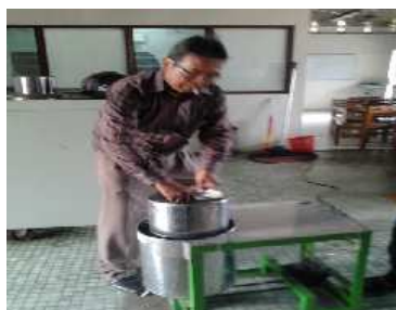
Gambar 21. Pengabdi sedang assembling mesin pemeras santan
