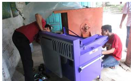
Gambar 3. Proses pengesetan mesin perajang rumput
