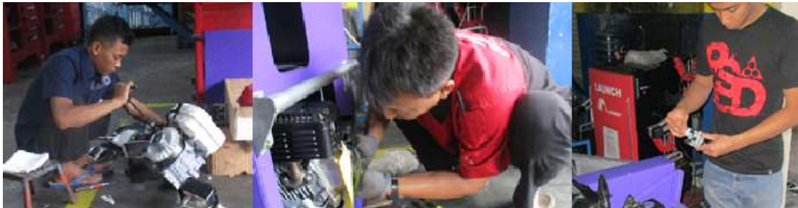
Gambar 2. Proses modifikasi mesin dengan penambahan mixer, mengeset waktu pengapian dan meningkatkan rasio kompresi
