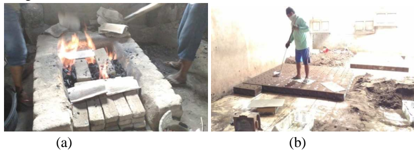
Gambar 8. Proses dewaxing pada investment casting .
