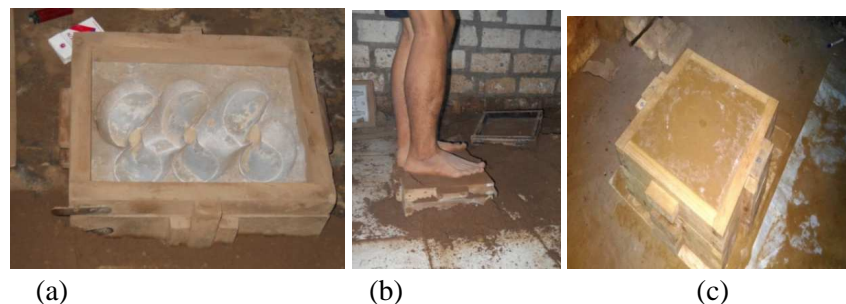
Gambar 6. Proses pembuatan cetakan dengan media pasir.
