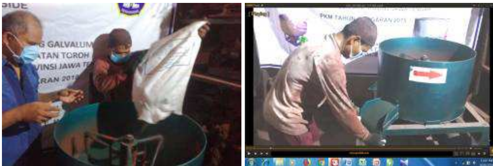
Gambar 12. Cara mengoperasikan Mesin pengaduk pasir dengan iron-oksida (Tim-PKM)
