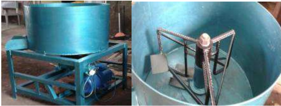
Gambar 11. Mesin pengaduk pasir dengan iron-oksida cara penggunaannya (program PKM)
