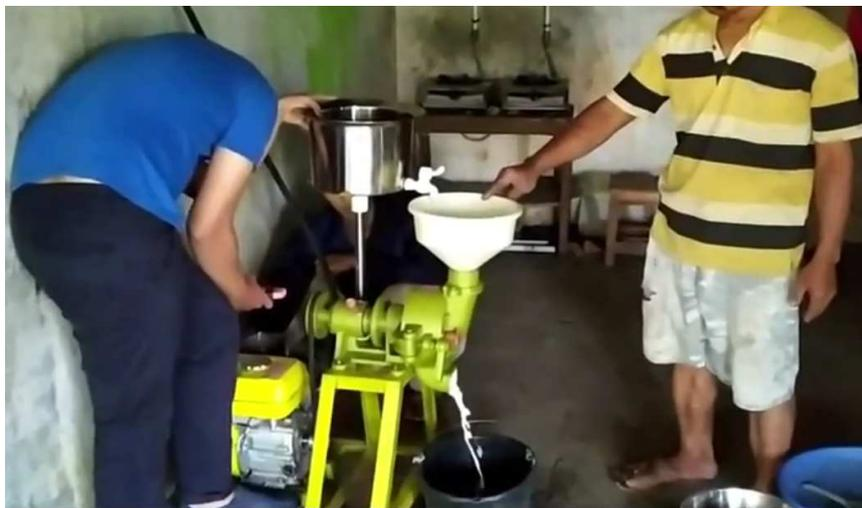
**Gambar 1. Mesin Penggiling Kedelai**
