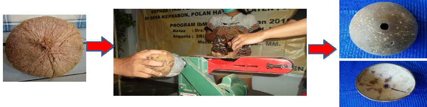
Gambar 7. Proses penghalusan bathok kelapa menggunakan mesin program IbM
