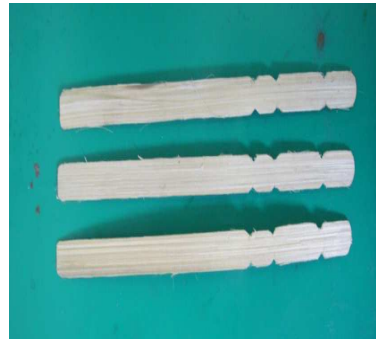
Gambar 11. Bilah bambu hasil pembentukan (1 x 12 x 190 mm)
