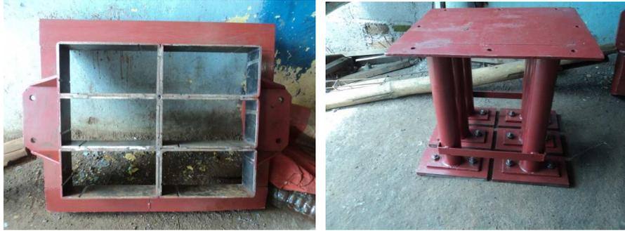
**Gambar 4. Cetakan paving dan alat pemadatnya.**
