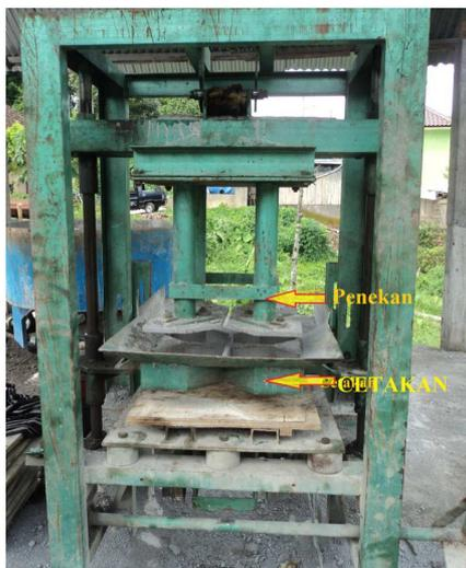
**Gambar 2. Cetakan manual Batako dan Paving.**
