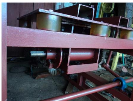
**Gambar 3. Poros exentrik dan sistim roda gigi untuk menghasilkan vibrasi.**
