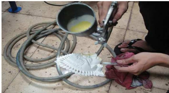
**Gambar 6. Pengecatan Dasar**
