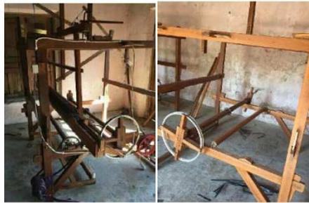
**Gambar 4. Proses merangkai pengrajin ATBM inovasi dengan bahan dasar kayu jati melamin fin, dan penambahan onderdil penggerak**
